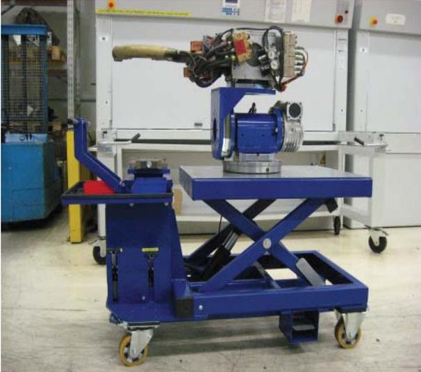
Dieser Montagewagen wurde speziell für Instandsetzungsarbeiten an Schweißzangen konzipiert. Er lässt sich sekundenschnell auf die ergonomische beste Arbeitsposition einstellen, um den Mitarbeiter bei seiner Tätigkeit zu entlasten.
