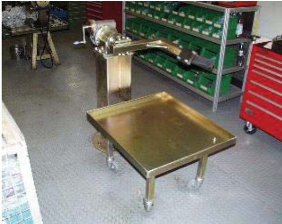
Diese Motormontagesäule wurde für einen großen deutschen Automobilbauer für die Versuchswerkstatt von Motoren entwickelt. Diese zeichnet sich durch einfache Handhabung Vielseitigkeit und Robustheit aus. Durch ein kompaktes Fußhydraulikaggregat kann sich der Arbeiter in sekundenschnell und mühelos seine ideale Arbeitshöhe einstellen.
